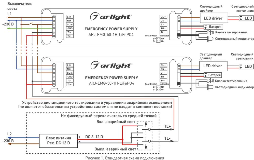
Подключите провод, постоянно подключенный к сети: **L** (фаза) — коричневый провод через **Выключатель света** ко входу **Slin** источника питания. Смотрите рисунок 1.
