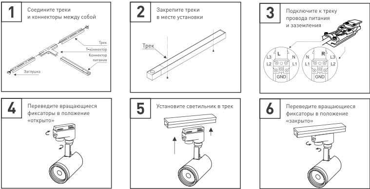
Рис. 2. Установка и подключение светильника
