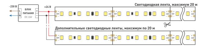
Схема подключения нескольких светодиодных лент с одной стороны.
