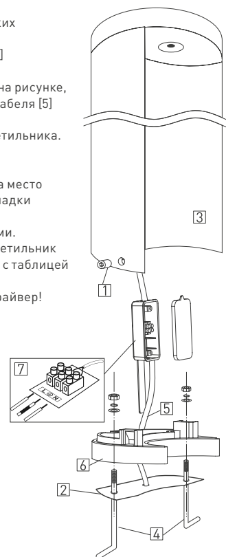
Рис. 2. Установка и подключение светильника
